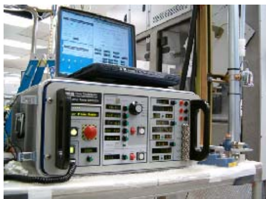
图 2.2 工业电压暂降发生器
